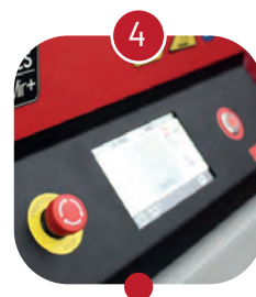
Nova e melhorada interface baseada na tecnologia de ecrã tátil, que permite comunicação em rede
